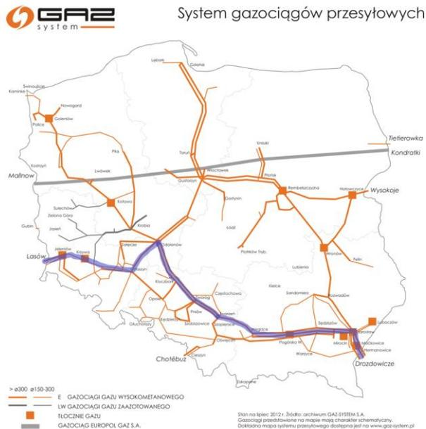
Abbildung 1: Das polnische Fernleitungsnetz, die simulierte Route wurde blau markiert.<sup>3</sup>
